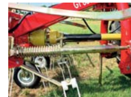
Disponible comme option: le stabilisateur latéral qui assure un travail sûr en pente pour les machines avec l'accrochement triangulaire pivotant. Le modèle GT 660 en est équipé en série.
