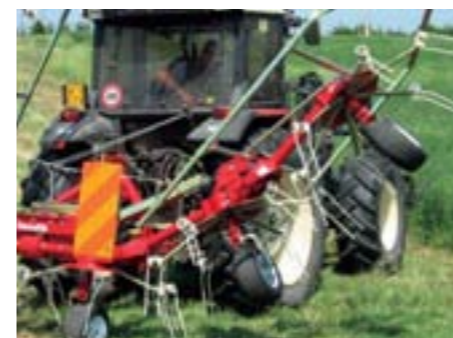
Relèvement hydraulique synchronisé en position de transport, disponible pour les modèles de GT 380 à 660.
