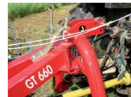
L'accrochage triangulaire pivotant augmente la manœuvrabilité, disponible pour les modèles GT 440/500/540 et 660.
