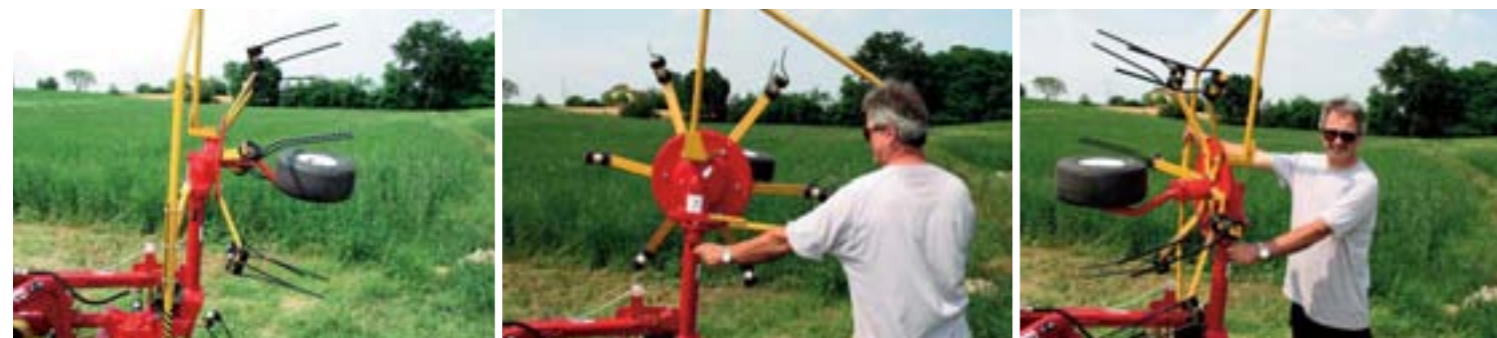
On peut tourner les rotors extérieurs de 180° pour réduire ultérieurement l'espace pour le transport. Disponible pour les modèles GTH 380-440-500-540-660-780.
