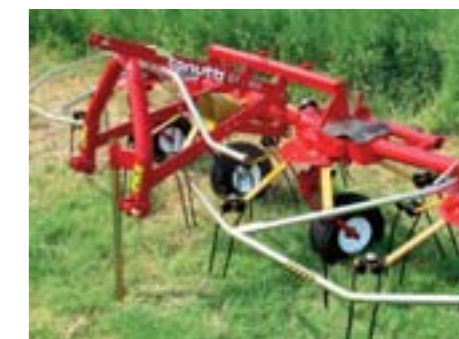
L'accrochage triangulaire fixe est disponible pour les modèles de 250 à 440. Il rend la machine parfaitement stable travaillant en pente ou sur les terrains montagnards.
