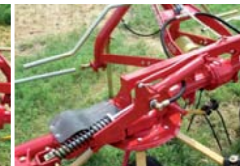
Avec le kit hydraulique, dans seulement quelques minutes, on peut transformer le mécanisme manuel du modèle GT 400 dans un système hydraulique.
