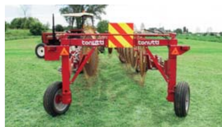
Die hydraulische Nachlaufenkung macht den Schwader extrem wendig und leicht manövrierbar auch bei kleineren Wiesen.
