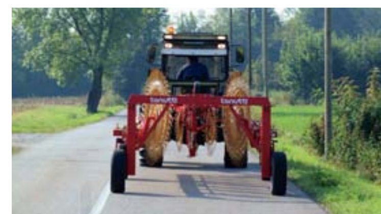
Einfacher und schneller Transport auf der Straße. Transportbreite 2.50 m (8' 4").
