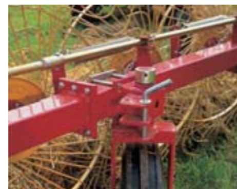
Arbeitsbreiteneinstellung durch Blockierung des Laufrades.
