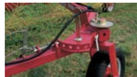
Arbeitsbreiteneinstellung am Rahmen mit frei drehbarem Lauftrad.
