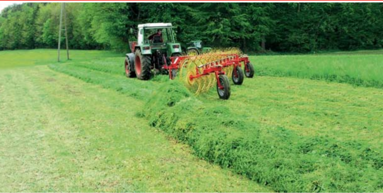
GEZOGENER SEITENSCHWADER T13 4GW mit 13 Sternrädern und 4 Laufrädern
