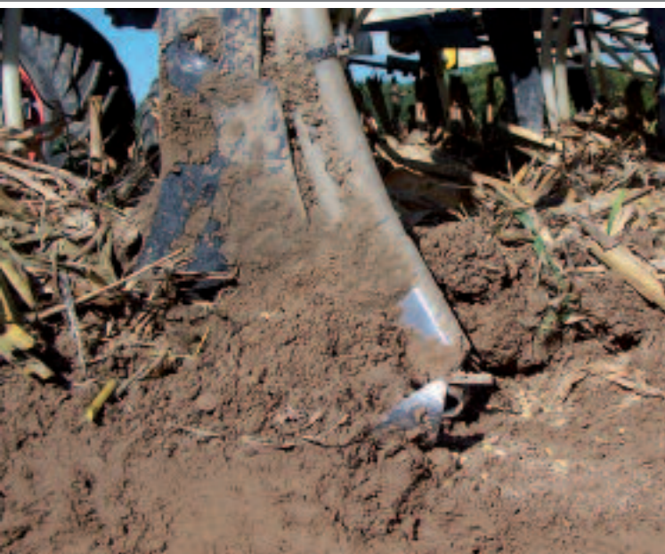
Dettaglio dell'OPENER in fase di lavoro
